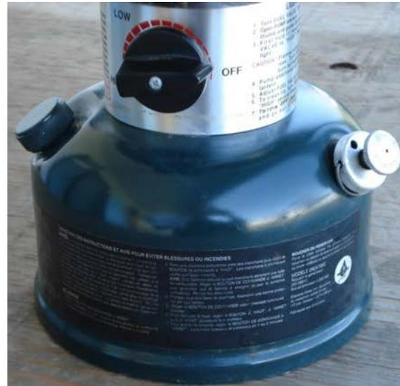
Figure 7 Réservoir de combustible
