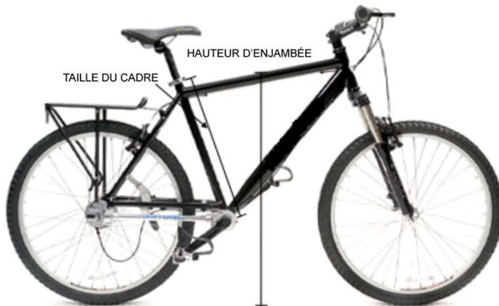
Figure 3 Mesures de la dimension
