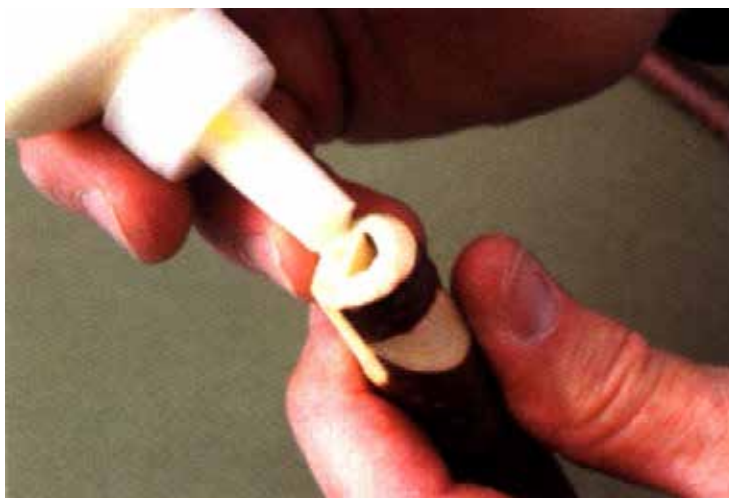
Figure A-11 Boucher les ouvertures avec de la colle
