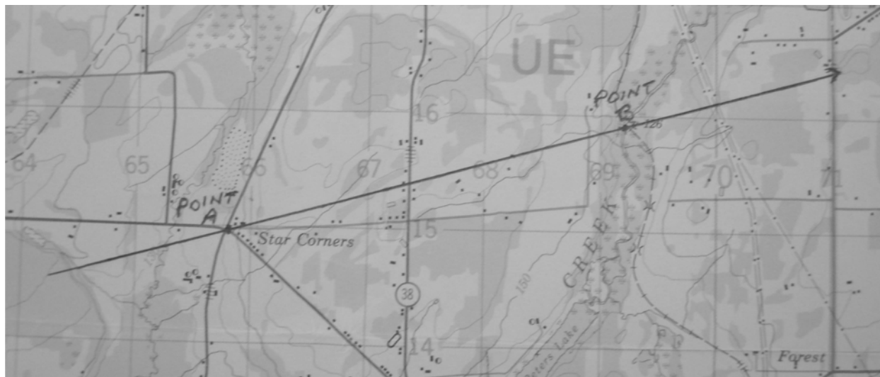
Figure 2 1 re étape à suivre pour mesurer un azimut de quadrillage à l'aide d'un rapporteur
