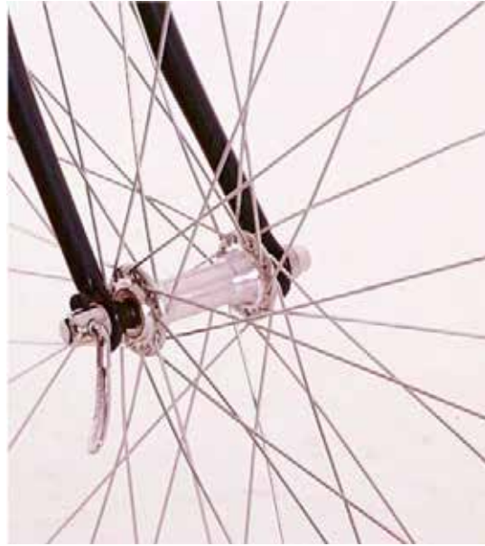
Figure 6 Mauvaise position du mécanisme de démontage rapide, premier exemple
