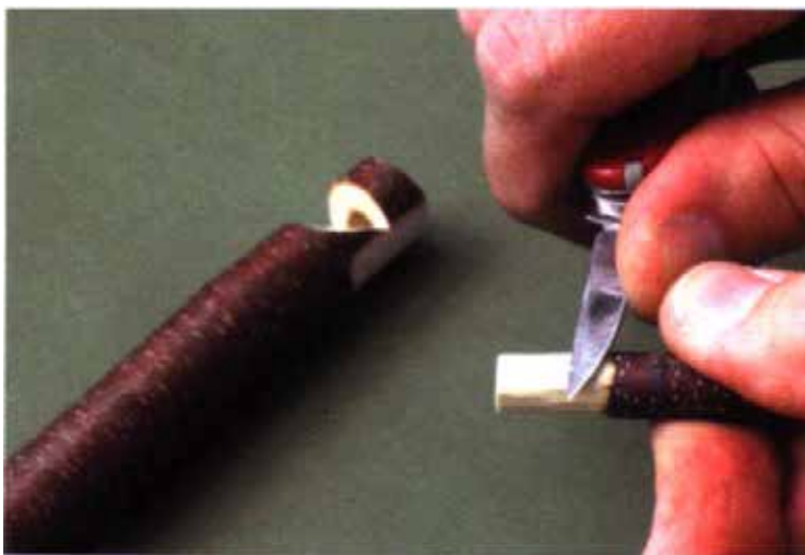
Figure A-7 Fabriquer un goujon
