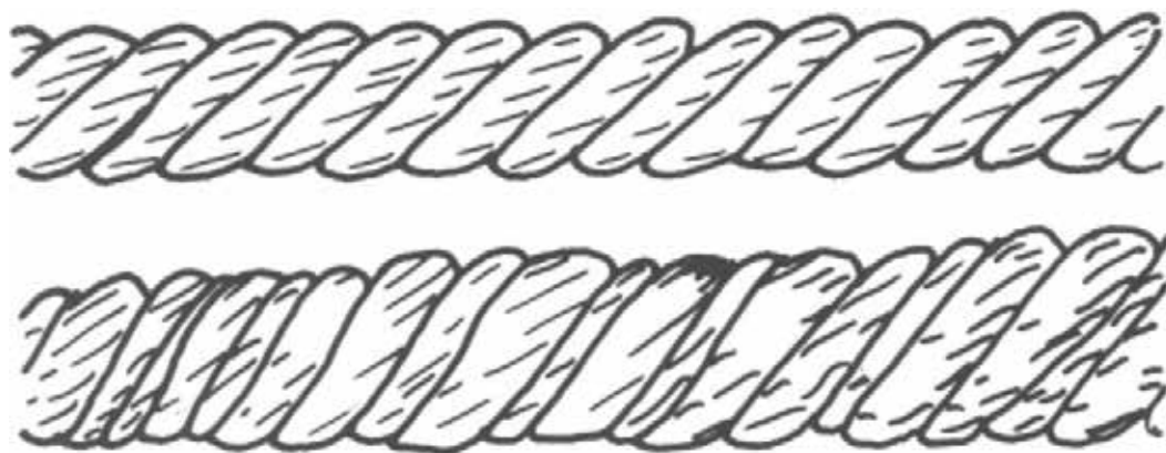
Figure 12 Exemple d'une tresse bien faite (haut) et d'une tresse mal faite (bas)
